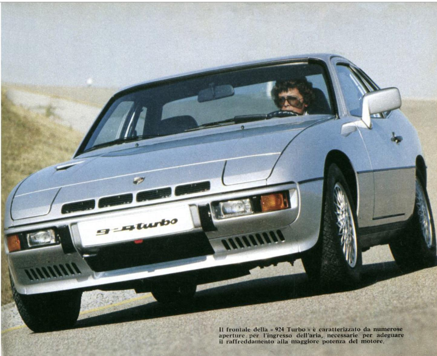
Il frontale della « 924 Turbo » è caratterizzato da numerose aperture per l'ingresso dell'aria, necessarie per adeguare il raffreddamento alla maggiore potenza del motore.
