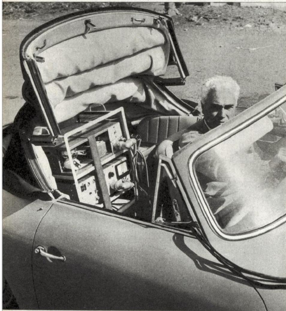
L'ing. Piero Taruffi al volante della Porsche « Super 90 »; sul sediletto posteriore è il « cronostatigrafo », il nostro apparecchio rilevatore delle prestazioni.
