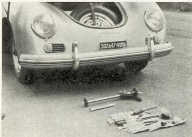
A sinistra: questi sono gli attrezzi di dotazione forniti di serie. A destra: la ruota senza il coprizzo. Si noti come questo, che arriva sino ai bulloni del fissaggio ruota, toglie la circolazione dell'aria al mozzo e alla parte del tamburo freno.
