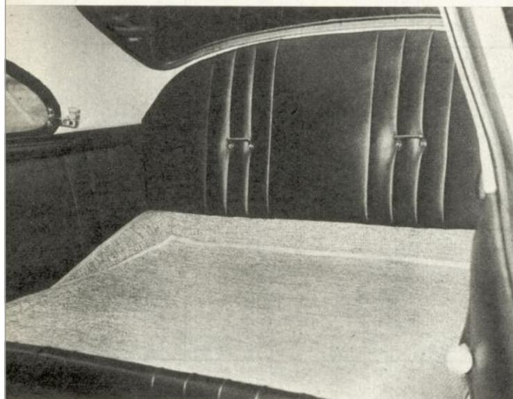
Il vano posteriore con la spalliera del sedile di fortuna abbassata e formante un piano per il bagaglio: si notino i passanti per le cinghie fissaggio bagagli.
